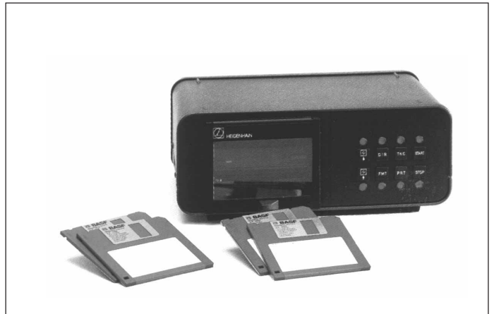
Fig. 1.6: HEIDENHAIN FE 401 Floppy Disk Unit
